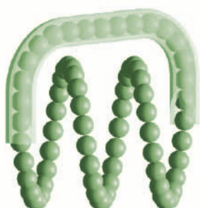
Rys. 3.4: Obieg kulek przy zewnętrznym mechanizmie przekierowania kulek
