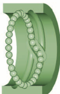
Rys. 3.5: Obieg kulek przy wewnętrznym mechanizmie przekierowania kulek
